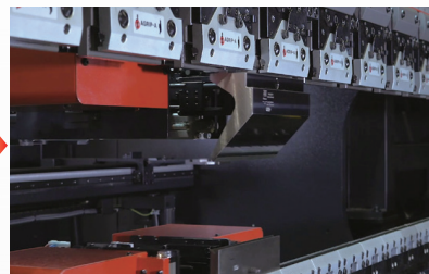
通过机械手进行准确的配刀
